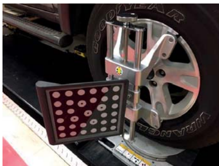
Zaciski AC 700 z mechanizmem samo-centrowania. Pasują do felg od 11" do 22"
