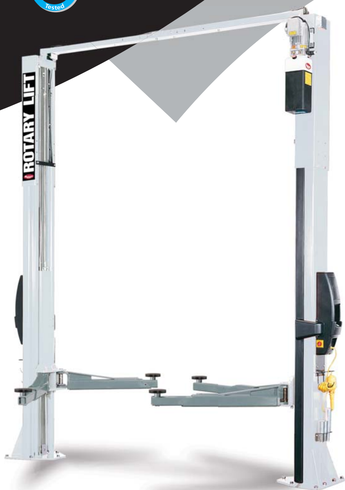
Mechaniczna blokada ramion zwalniana automatycznie po opuszczeniu pojazdu
